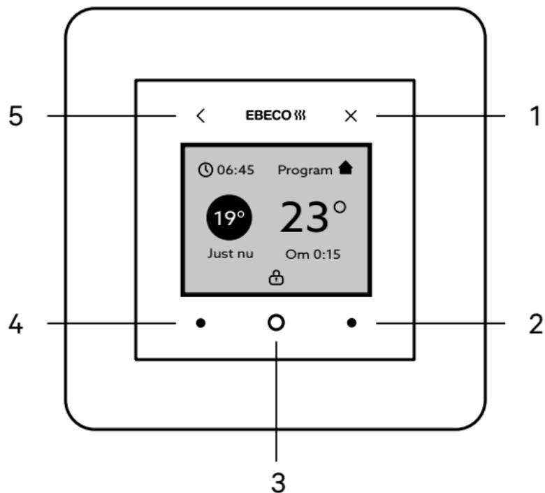
EB-Therm 500 ima određen broj površina osetljivih na dodir na prednjem delu termostata. Ove površine su osvetljene i van su samog ekrana.
